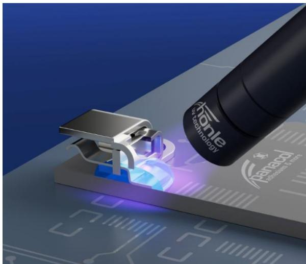
Vitralit® UD 8055 – hier blau dargestellt – wird als Konnektorverguss mit dem bluepoint LED von Hödle ausgehärtet; die Aushärtung des Schattenbereichs unter dem Konnektor erfolgt durch Feuchtenachvernetzung.
